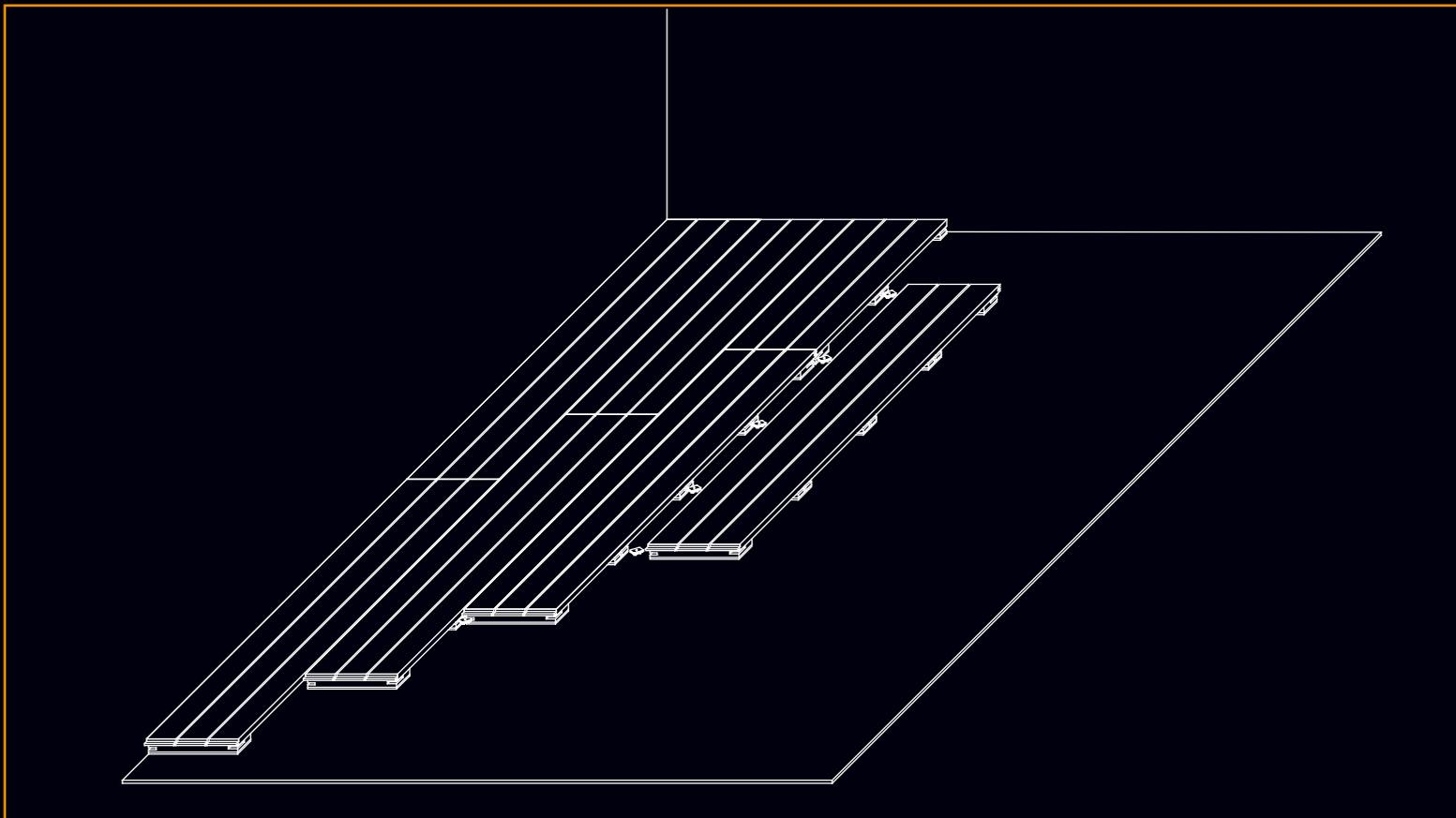
Pour un rendu plus esthétique, les modules *Trendy Deck Floor* sont conçus pour permettre une pose à l'anglaise (joints en bout décalés entre les rangées)
